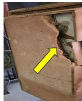
Foto 8: Schade aan de vuurvaste bekleding
